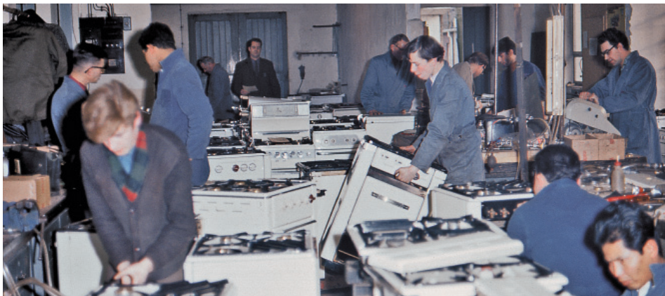
1966 werden über 20.000 Gasgeräte in nur vier Monaten entweder vor Ort beim Kunden oder in der Umbauwerkstatt der Stadtwerke auf Erdgas umgestellt
